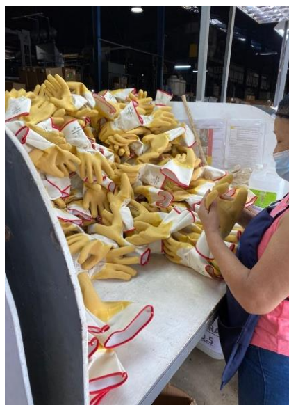
Figura 28. Inspección a guante terminado
