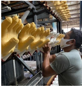
Figura 25. Moldeo y desmoldeo de shell/guante
