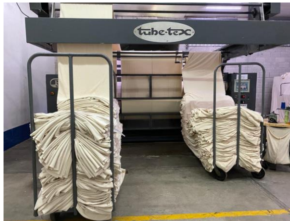
Figura 17. Máquina napper en proceso de afelpado
