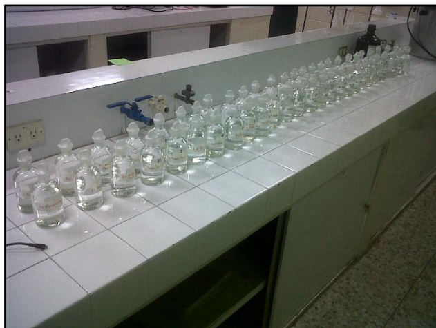
Fotografía 2. Análisis de \text{DBO}_5 , a nivel laboratorio.
