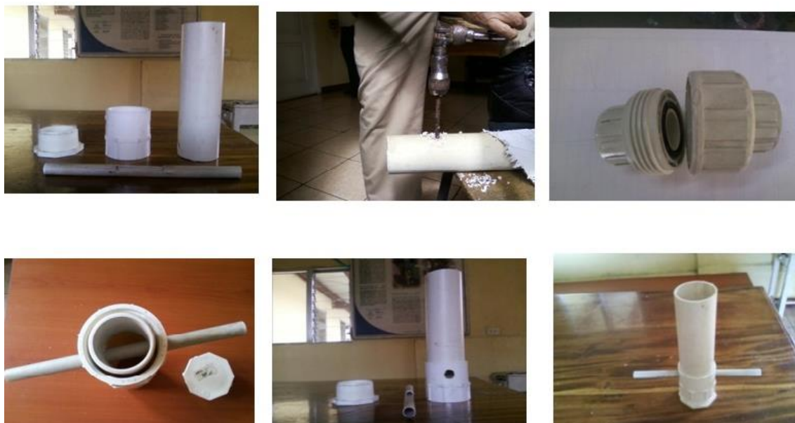
Figura 2. Diseño de hipoclorador implementado en Finca El Cascajal
