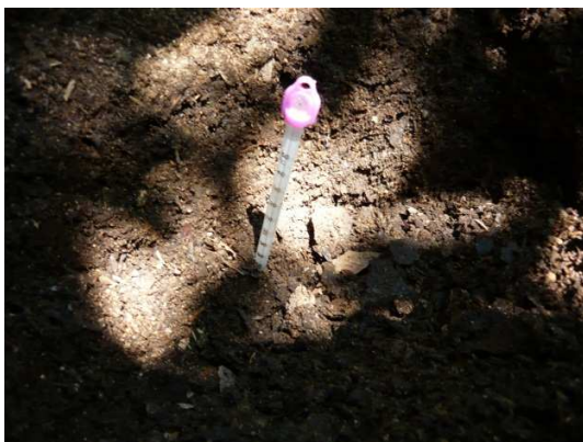
Fig. 15. Toma de temperatura en aboneras
