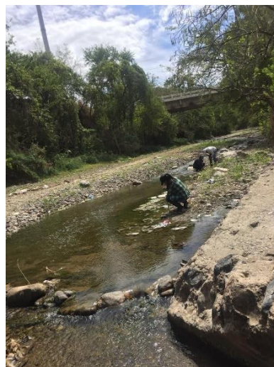
Fotografía 28 y 29. Aforo en el Río Torjá de Camotán con el método del flotador.
