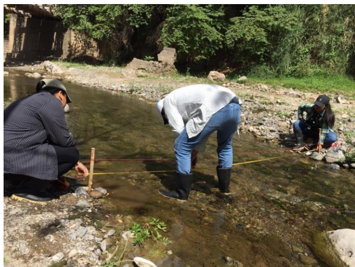
Fotografía 28 y 29. Aforo en el Río Torjá de Camotán con el método del flotador.
