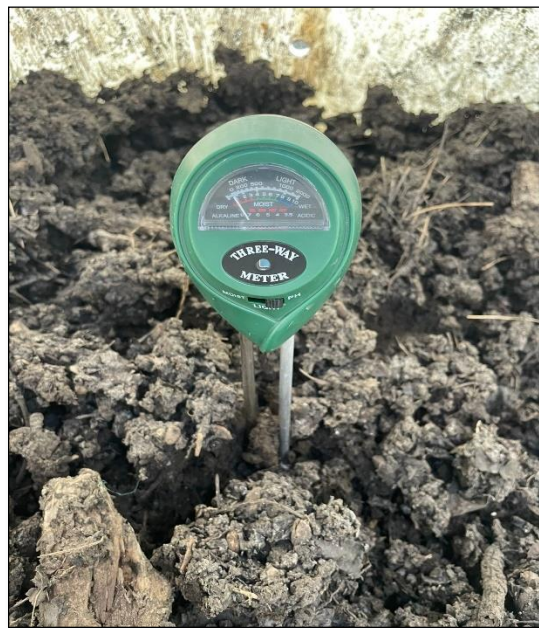
Fotografía 11: Toma de muestra de pH de compost.
