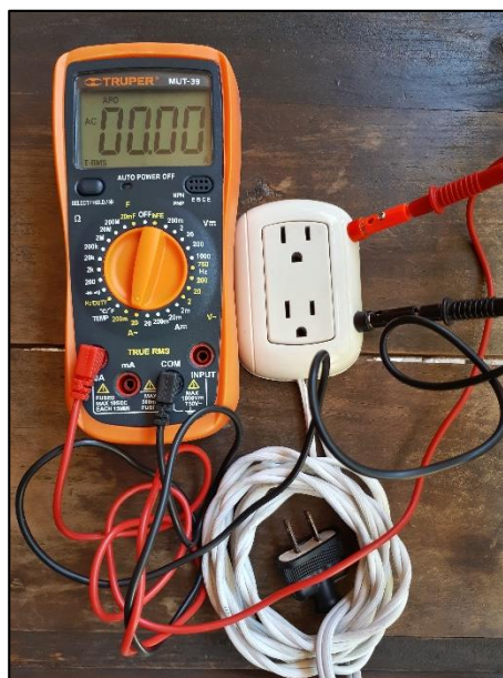
Fotografía 4. Multímetro y adaptador de corriente para la medición de tensión.
