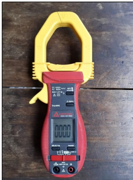
Fotografía 2. Pinza amperimétrica utilizada para la medición de intensidad.
