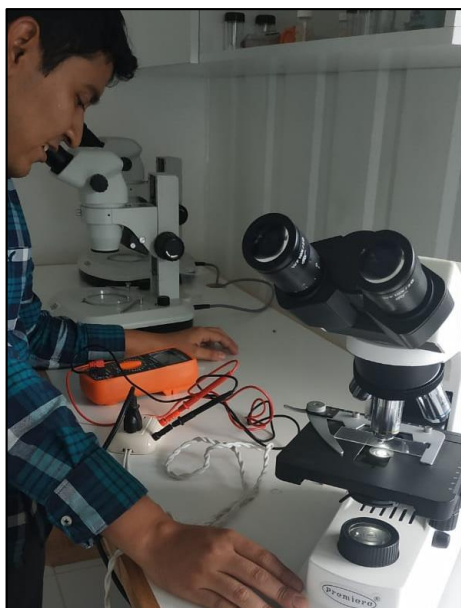
Fotografía 7. Medición de intensidad con multímetro en equipos de laboratorio.
