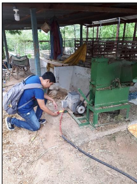
Fotografía 8. Medición de intensidad con pinza amperimétrica en equipos industriales.
