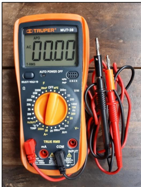
Fotografía 1. Multímetro utilizado para la medición de tensión.
