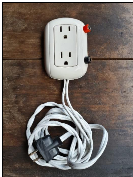
Fotografía 3. Adaptador de corriente utilizada para la medición de tensión.
