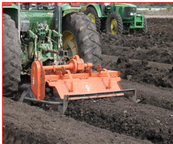
Fig. 10 Vista trasera del Rotovator.
