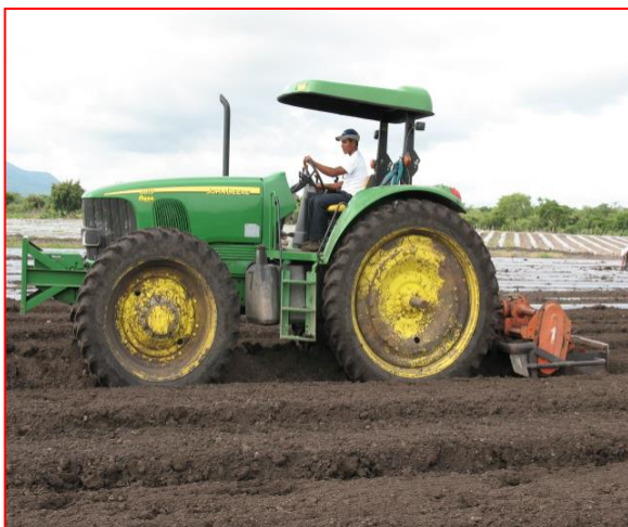
Fig. 9 Mullido del suelo con el paso de Rotavator.
