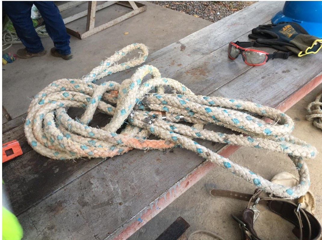
Figura 25. Estado actual de maneads del personal técnico de líneas de transmisión
