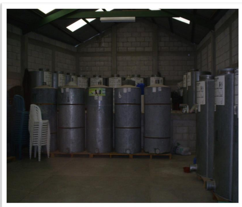
Fotografía 2: Silos para almacenamiento de frijol.
