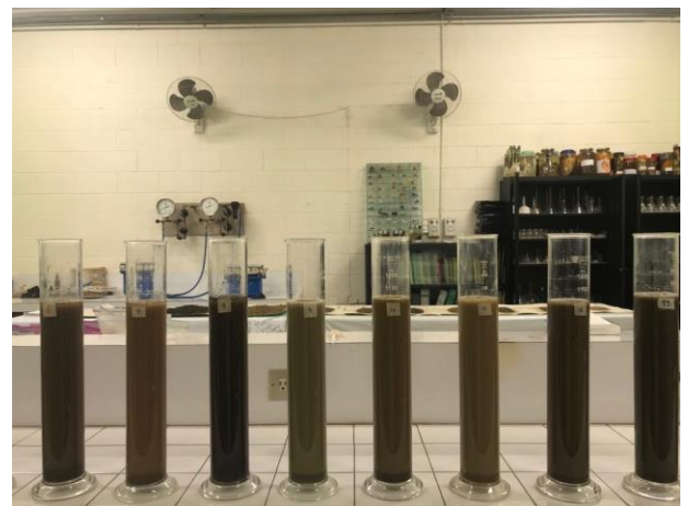
Figura 7. Práctica para determinar las texturas utilizando el método del hidrómetro
