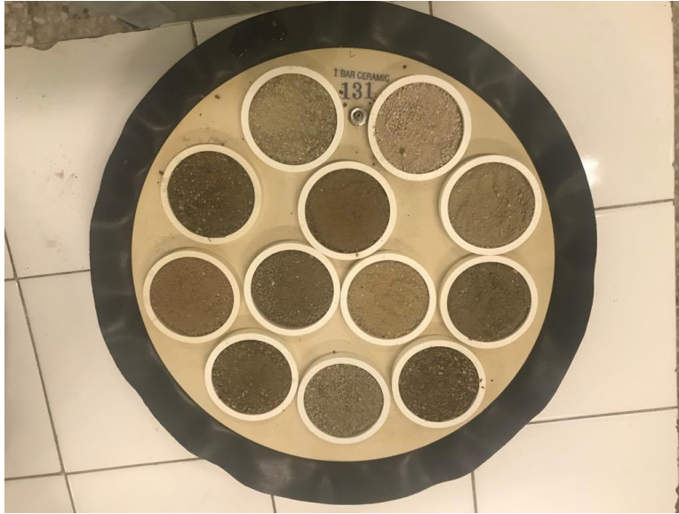
Figura 8. Preparación de muestras para realizar el método de ollas de presión para determinar la capacidad de campo y el punto de marchitez permanente.
