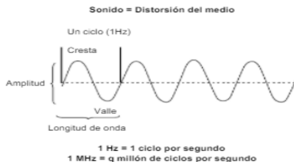
Figura 5. Características de la onda sónica
