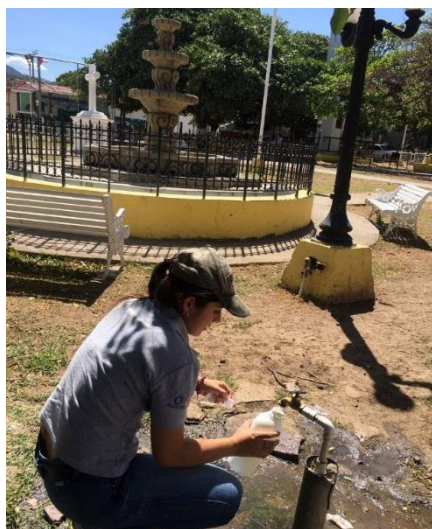
Figura 27. Recolección de muestra de agua para análisis físico-químico.
