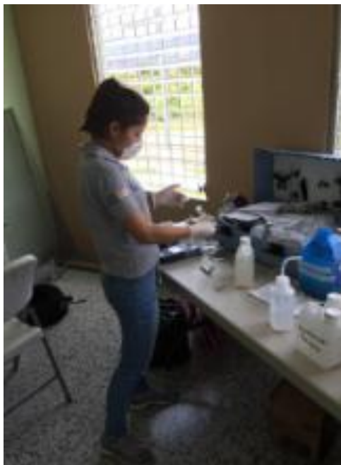
Figura 24. Análisis físico-químico con kit multiparamétricos, de muestras de agua de pozo.
