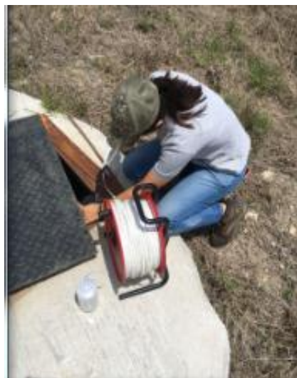
Figura 26. Determinación del nivel freático en pozo artesanal.
