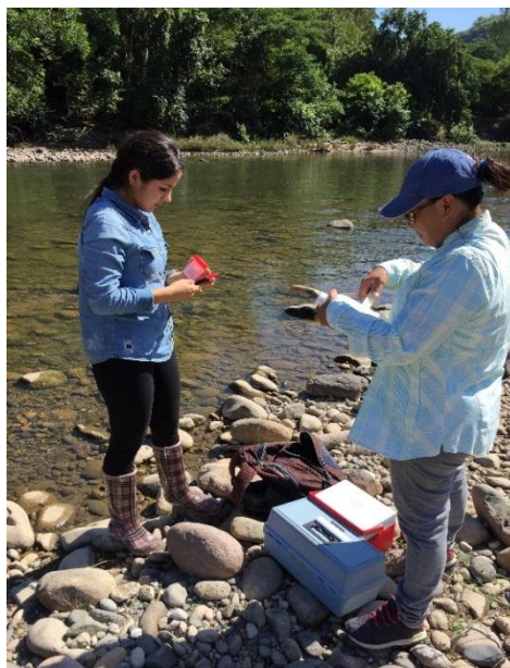
Figura 21. Etiquetado de recipientes previo a la toma de muestra.
