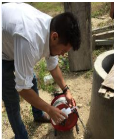
Figura 25. Lavado de sonda piezométrica.
