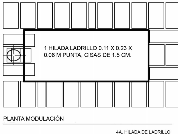
Figura 7. Planta de modulación 4ta hilada de ladrillo
