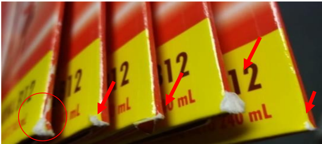
Figura 9. Empaques reventados por exceso de humedad
