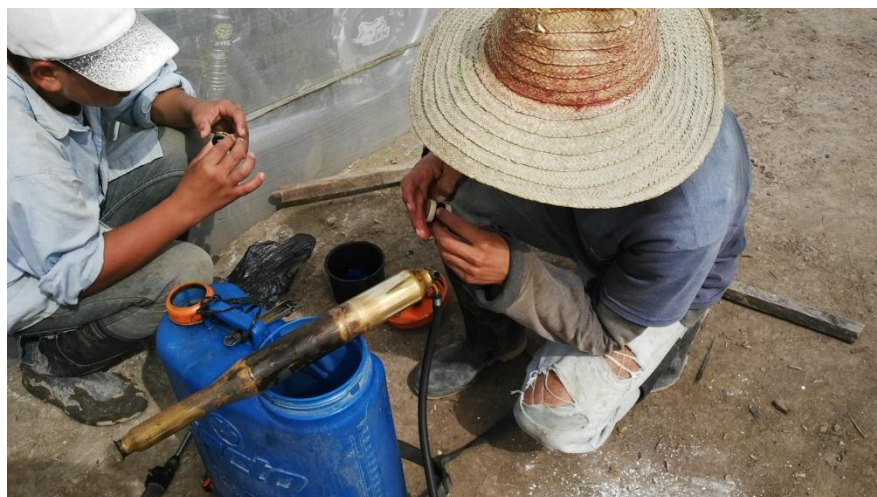
Figura 4. Reparación de equipo, cambio de empaques a bomba de mochila
