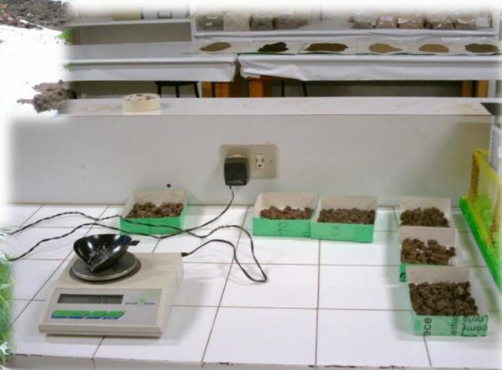
Peso de suelo seco en laboratorio
