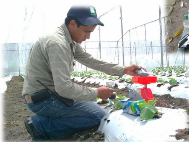
Toma de muestras de suelo para calibración de tensiómetros en el campo
