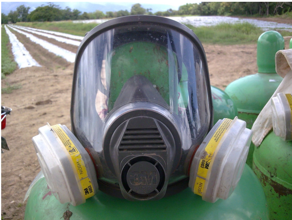
Figura 20. Equipo de protección para la desinfección con telone.
