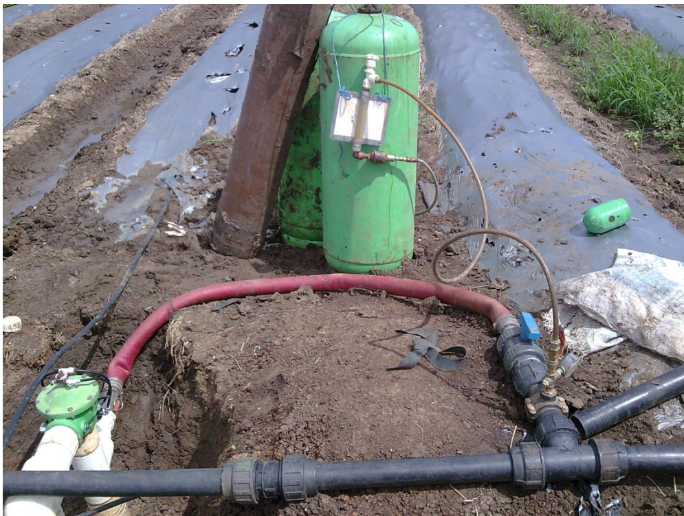
Figura 22. El cilindro de hidrógeno (color marrón) le da mayor presión al de telone (color verde), de esta manera es inyectado en la tubería móvil que sale del hidrante, para evitar dañar la tubería de PVC.
