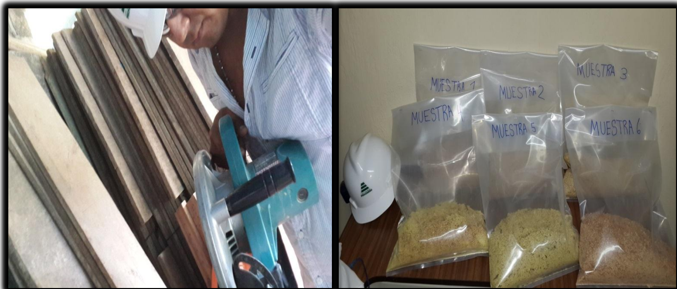
Figura 19. Extracción de 3l de aserrín por muestra.
