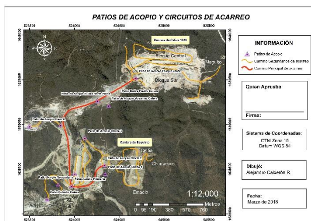
Imagen 3. Mapa elaborado para representación de circuitos de acarreo en área de extracción, planta San Miguel.
