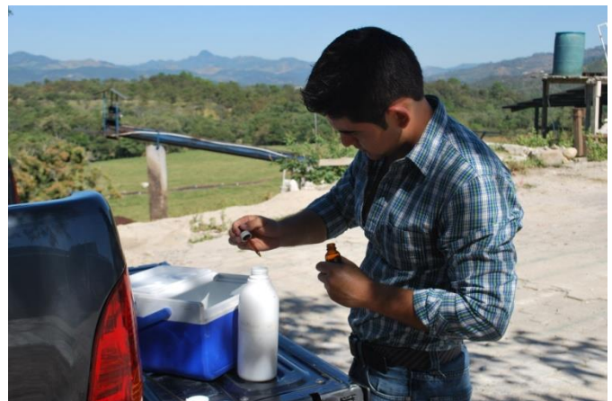
Fotografía 12. Aplicación de ácido para análisis de la DQO (demanda química de oxígeno) en el laboratorio
