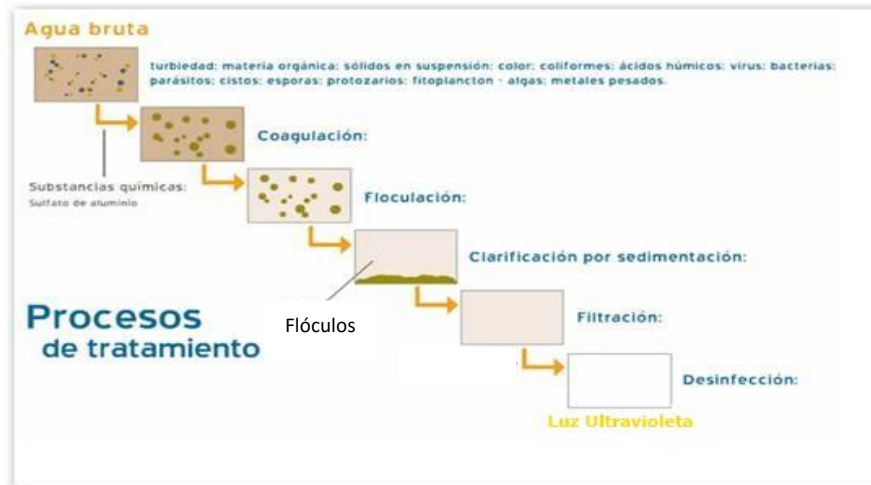
Figura 5: Operaciones unitarias del sistema CEPIS
