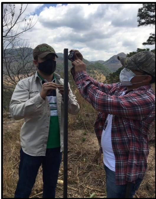
Foto 5. Instalación de pluviómetro en Tuticopote Olopa.
