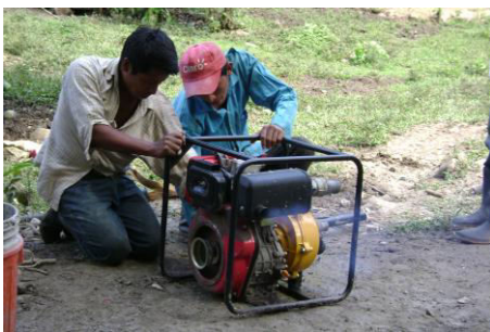
FIGURA 3. Bomba de Agua para el riego.
