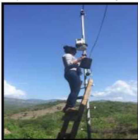
Fotografía10: limpieza a estación meteorológica ubicada en ADIPAZ (Zacapa)
