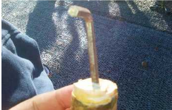
Figura 9. Ilustración de la herramienta para realizar el entorchado.
