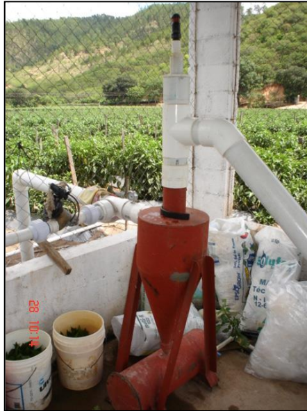
Fig. 1 Desarenador y filtro del Sistema de riego
