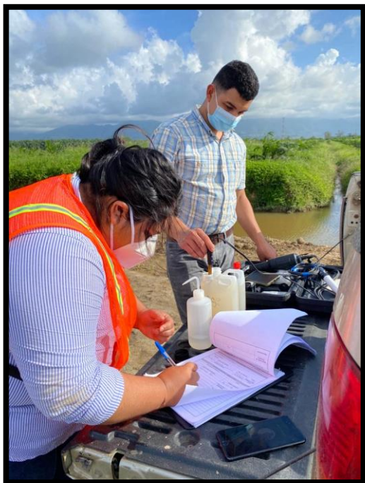
Figura 1. Toma de datos de los parámetros in situ de muestra de agua superficial.
