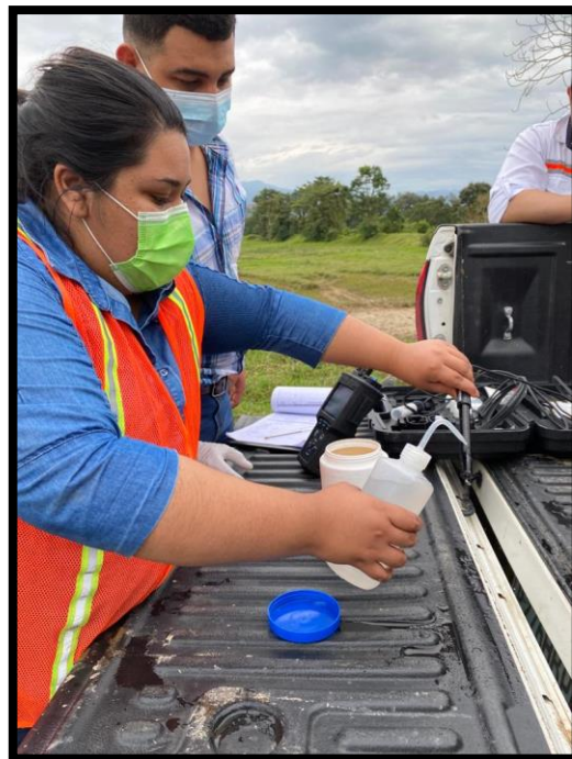
Figura 2. Toma de conductividad y temperatura de muestra de agua potable.
