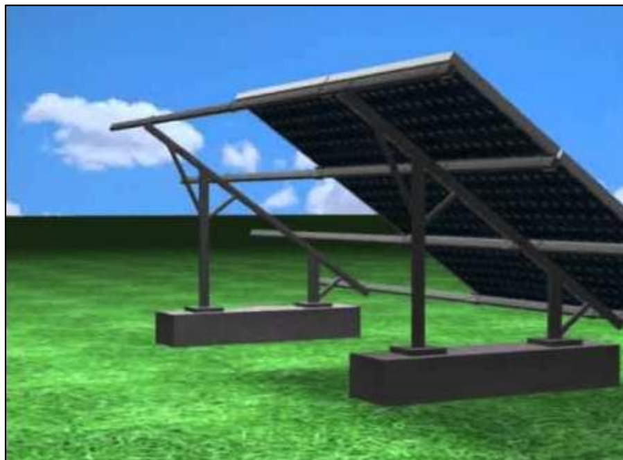
Figura 3. Diseño de la estructura para paneles fotovoltaicos.
