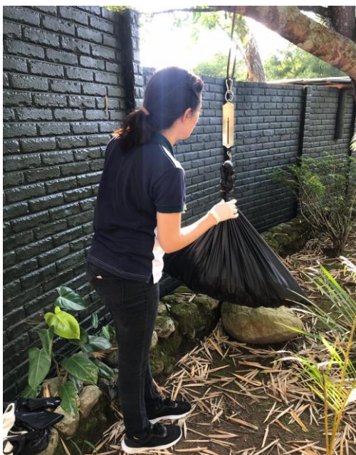
Fotografía 6. Pesaje de residuos ya clasificados por su tipología.
