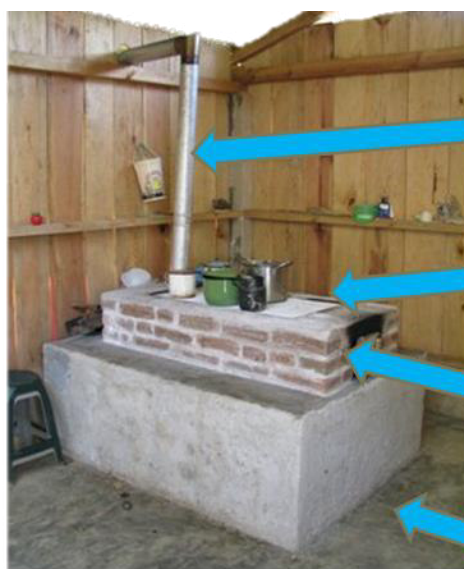
Figura 1. Componentes de una estufa ahorradora de leña-
